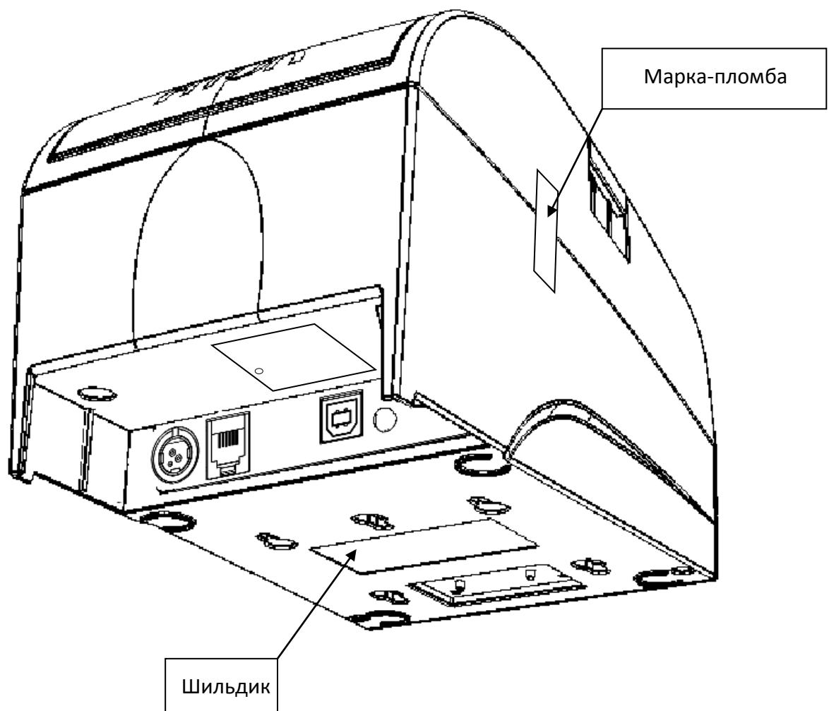
Один элемент марки-пломбы наклеивается на кожух, закрывающий блок управления и устройства печати кассовых чеков так, чтобы было невозможно получить доступ к внутренней части ККТ без разрушения марки-пломбы. Шильдик наклеивается на дно корпуса ККТ.
